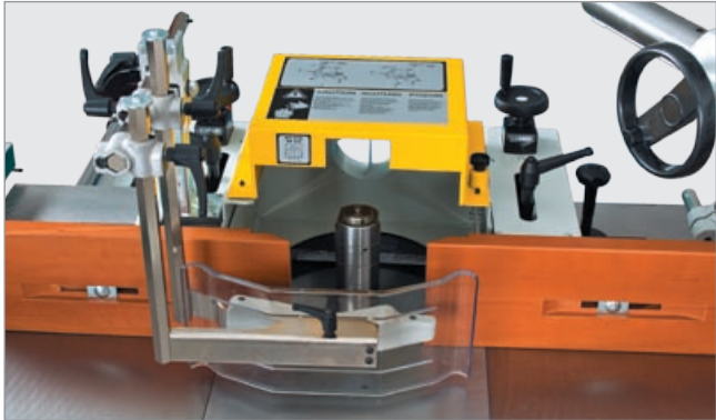
S Profilovací kryt frézky • Safety protection for profiles Profilschutzhaube • Protección de seguridad para profiles Guide pour le travail à l'arbre • Профильный кожух
