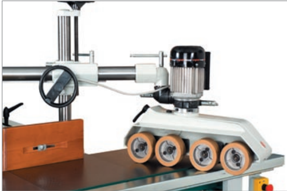
O Podávací zařízení • Feeding device Vorschubvorrichtung • Dispositivo de avance Entraîneur • Крепление автоподатчика
